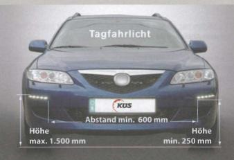
Bei der Verwendung als Positionslicht muss die Mindestbauhöhe 350 mm betragen und der von der Fahrzeugmitte am weitesten entfernte Punkt der Leuchtfläche darf nicht mehr als 400 mm vom äußersten Punkt der Gesamtbreite des Fahrzeuges entfernt sein.
